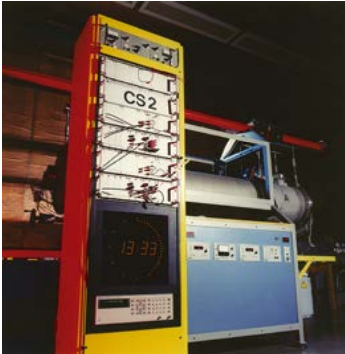
Die primäre Atomuhr der PTB, mit der z.Zt. UTC (PTB) realisiert wird.
